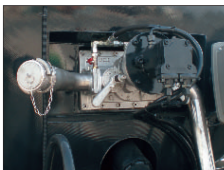
Bomba de betón sumergida de actuamiento hidráulico.
